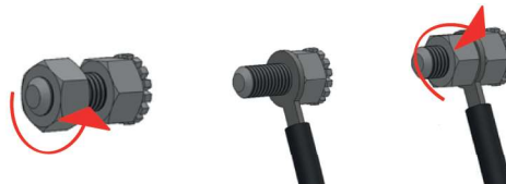
Bild 7. Der Anschluss des Gerätes an die Potentialausgleichsanlage
