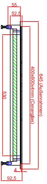
Variante "B" Ausschnitt in Abdeckung flächenbündiger Einbau 406mm x 606mm
