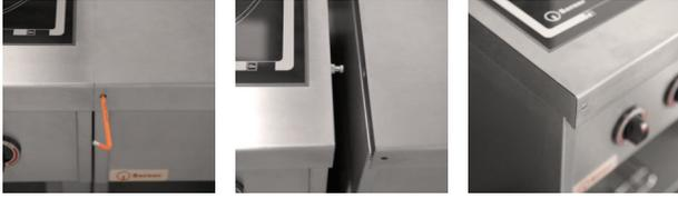
Flächenbündiges Verbindungssystem mit hygienischer Haarfuge. Abdeckung seitlich scharfkantig ausgeführt. Seitenflanken mit Bolzen und Bohrungen für integrierte Zugschiene. Geräte können mit 6-kant Schlüssel fest verbunden und wieder gelöst werden.
