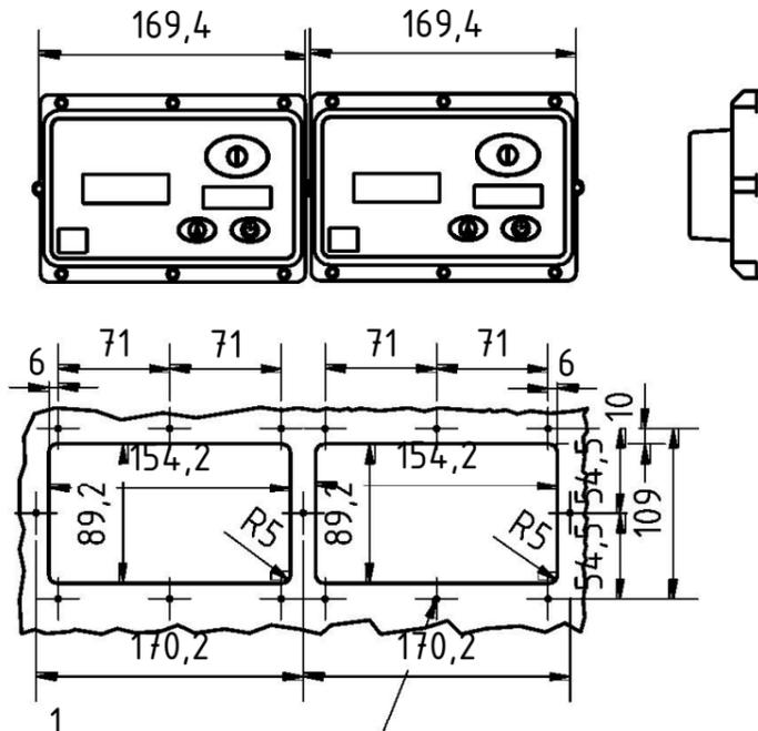
M3x10 auf Rückseite Schweißbolzen setzen
